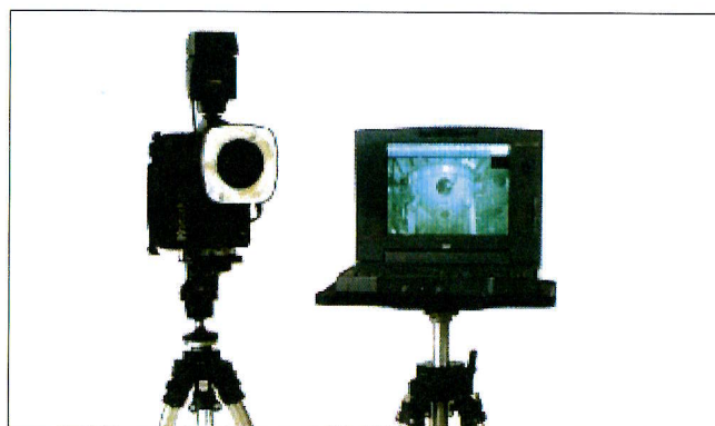
Figure 538. Caméra à film Kodak avec Notebook : précision de 0,11 mm pour un objet de 10 m © Leica
