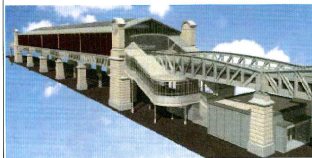
Figure 546. Relevé photogrammétrique et modélisation 3D d'une station de métro © Malenfer
